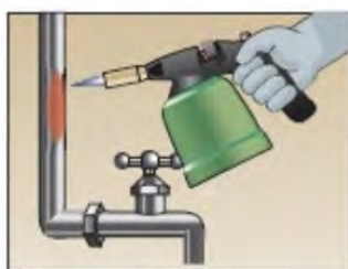
Solda em redes hidráulicas
