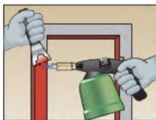
Aquecimento de esquadrias e chapas
