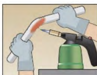
Dobramento de tubos
